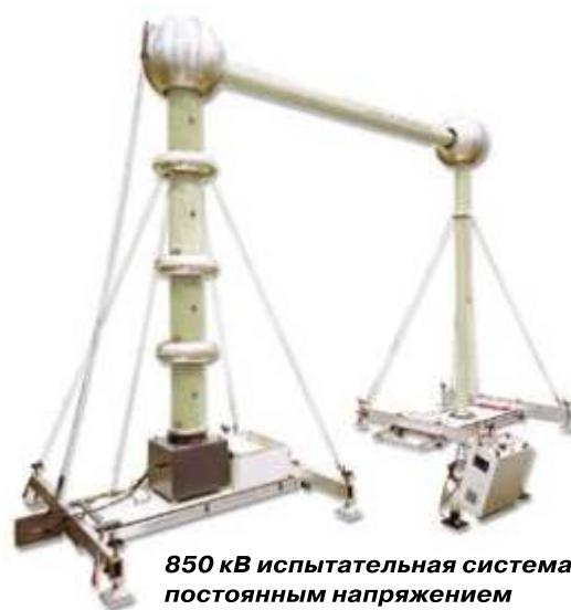
850 кВ испытательная система постоянным напряжением
